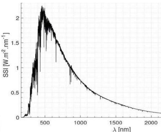
4.2.5. Le profil spectral du Soleil a l'allure ci-contre, en utilisant le graphe et la loi de Wien, évaluer la température de surface du Soleil en kelvin puis en °C (attention à la conversion de longueur d'onde).
