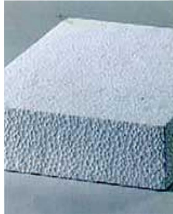
La produzione di EPS è inquinante; va però evidenziato che il **bilancio energetico** di un isolamento termico realizzato in EPS risulta positivo già dopo **7 - 20 mesi**.
