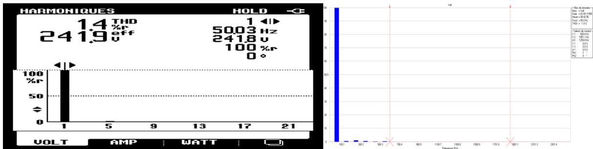
4. La tension délivrée par le fournisseur d'électricité est de qualité car la tension est bien compris entre 207V-253V, la fréquence est bien entre 49Hz-51Hz et la pollution harmonique est faible.
