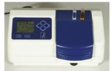
$A = k \cdot C$ . Un spectrophotomètre est un appareil qui permet de mesurer l'absorbance d'une solution colorée pour une longueur d'onde donnée. Le réglage du zéro d'absorbance doit être fait sur le solvant à chaque fois que la longueur d'onde de travail est modifiée.
