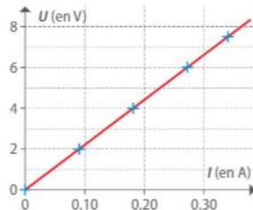
Caractéristique d'un résistor de 22  $\Omega$ .
