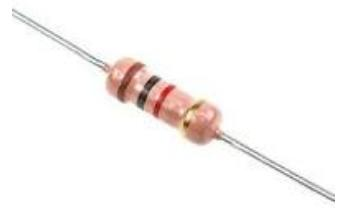
Un conducteur ohmique est caractérisé par une grandeur appelée résistance électrique, représentée par la lettre R dont l'unité est l'ohm (symbole  $\Omega$ ).
