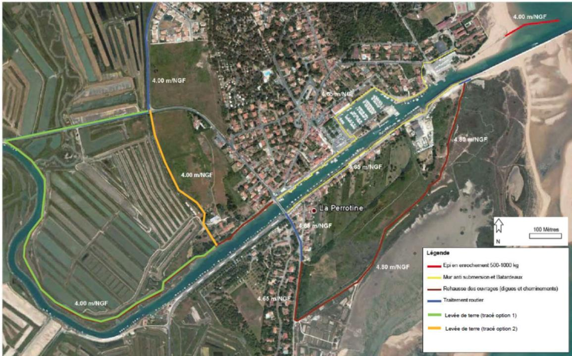
Figure 35 : Vu en plan de l'ensemble du chantier de Boyardville (Saint Georges d'Oléron)
