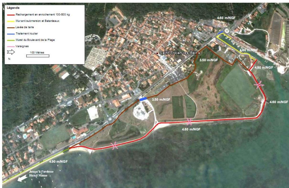
Figure 38: Plan global de l'aménagement du système d'endiguement à Saint-Trojan Les Bains
