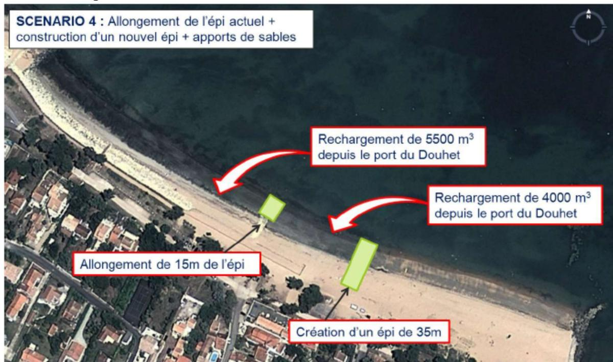
Figure 25: Représentation schématique du scénario retenu pour le secteur 2
