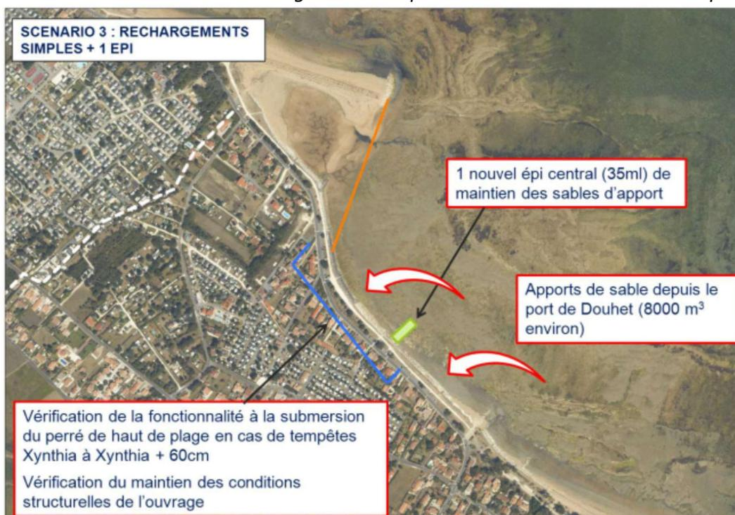
Figure 24: Représentation schématique du scénario retenu pour le secteur 1
