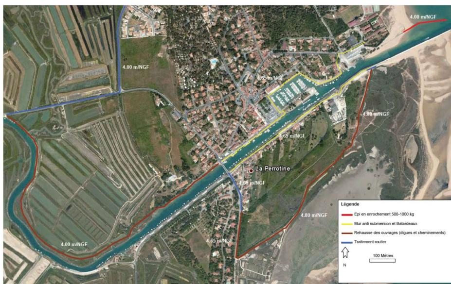
Figure Travaux prévus pour la protection anti-submersion du secteur de Boyardville/La Perrotine
