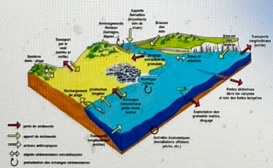
Schéma n°1 : représentation simplifiée des phénomènes à l'œuvre sur le littoral
