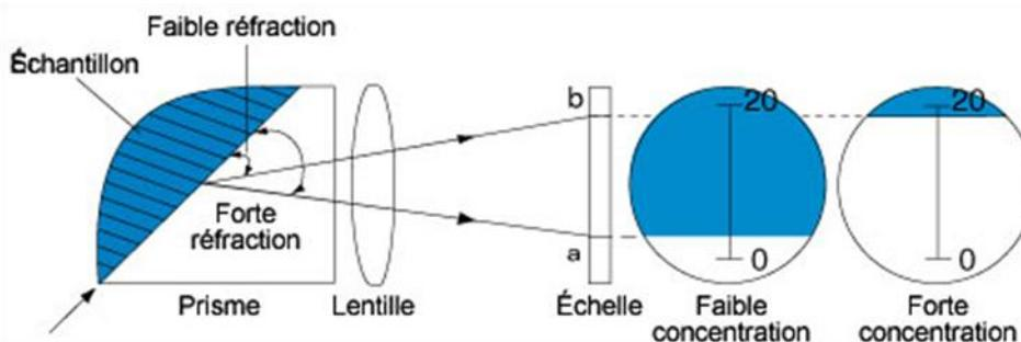
**Mode d'emploi :** On dépose une goutte de liquide sucré puis, au travers de l'œilleton, on relève la valeur du pourcentage de sucre sur la graduation de gauche à l'intersection des deux parties de couleurs différentes. Ici, la mesure est de 13% soit 13 g de sucre pour 100 g de liquide.
