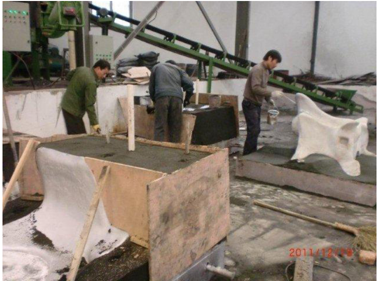
Fabrication des moules à partir des scans échelle 1. © LVAN.
