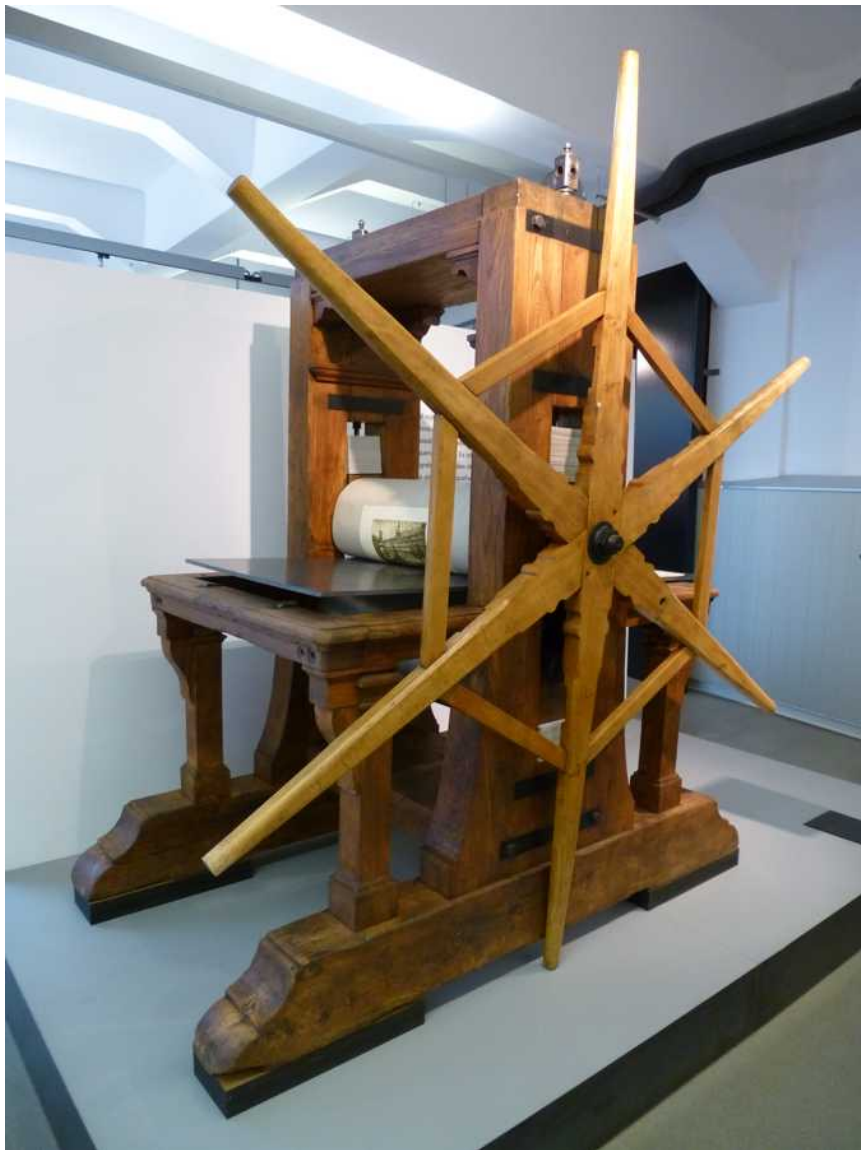
Presse à imprimer Plaque gravée et tirage d'impression
